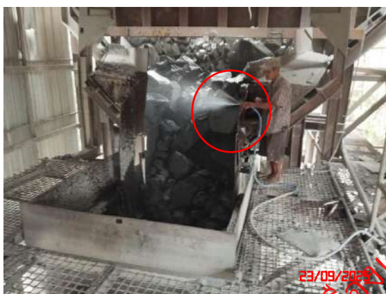
ระบบสายพานน้ำบริเวณแหล่งกำเนิดฝุ่นละออง
